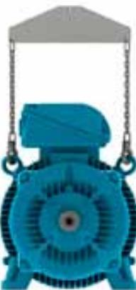
*Figura 4.6 – Uso de barra separadora en el izamiento.*
