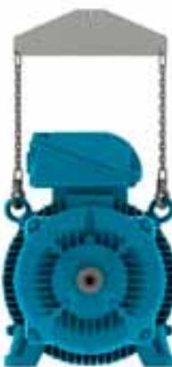
Figura 4.6 – Uso de barra separadora no içamento.
