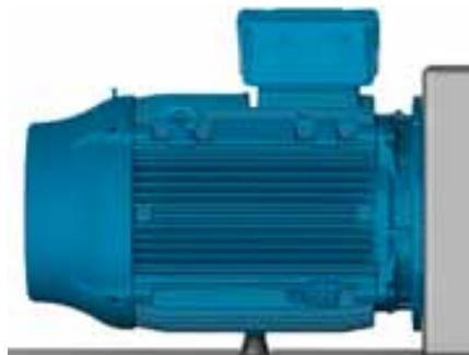
**Figura 6.7** – Representação da fixação do motor com flange e apoio na base da carcaça.
