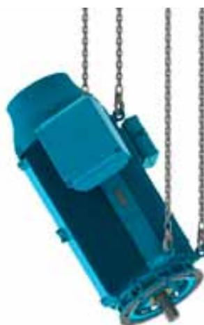
**Figura 4.13 - Colocação de motor HGF na vertical.**
