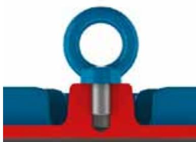
**Figura 4.1 – Maneira correta de fixação do olhal de içamento.**
