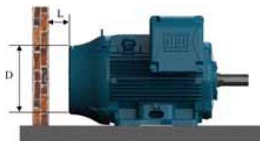
*Figura 7.1 - Distancia mínima del motor hasta la pared.*
