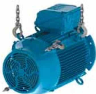
*Figura 4.10 – Instalação do segundo par de olhais.*
