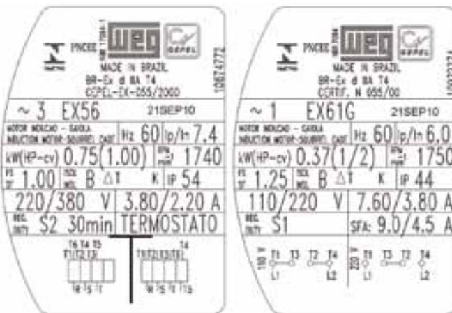
Figura 2.3 - Placa de identificação de motor para bomba de combustível.
